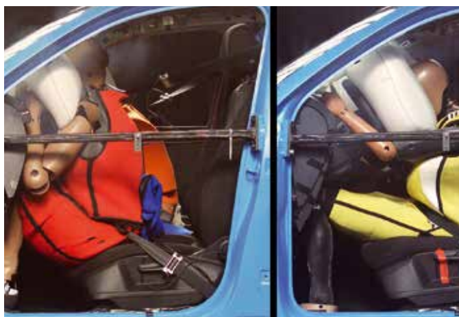
Groß, klein, dick, dünn – die Schutzwirkung von Gurten und Airbags je nach körperlicher Beschaffenheit im ADAC Test (Foto: ADAC/Ralph Wagner.)
